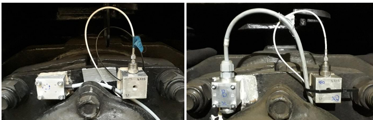
Obr. 7 Snímače různého provedení pouzdra a měřicí technologie během testování na měřicím voze
