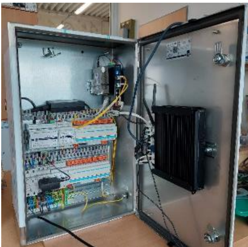
Obr. 1 Zařízení pro měření dynamické odezvy DiPo
