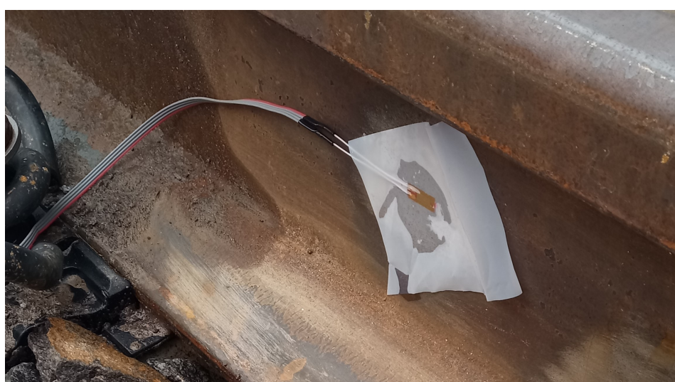
Obrázek 3: Připevnění tenzometru rychlevytvrzujícím lepidlem 1-Z70.
