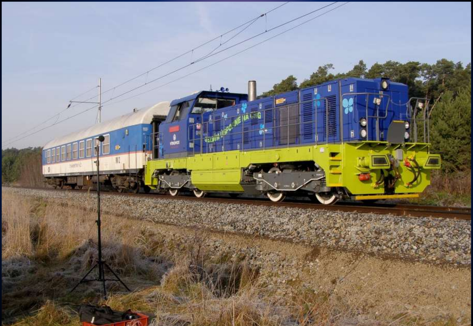
Měření hluku lokomotivy 714.811 s pohonem na CNG na přímém úseku malého zkušebního okruhu.
