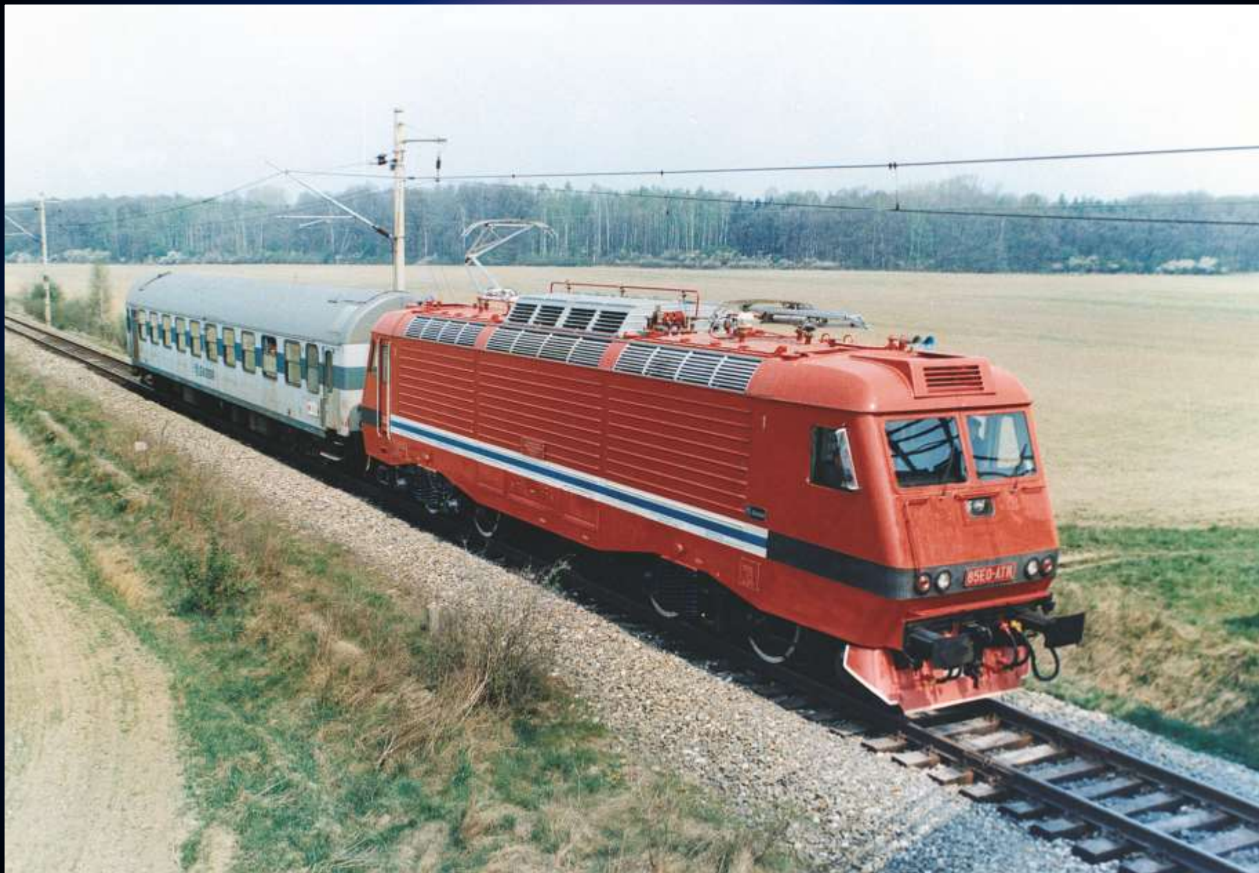
„Asynchron“ 85E0-ATM (později 169.001) při zkouškách s měřicím vozem ŠKODA na „zadní přímé“ velkého zkušebního okruhu.
