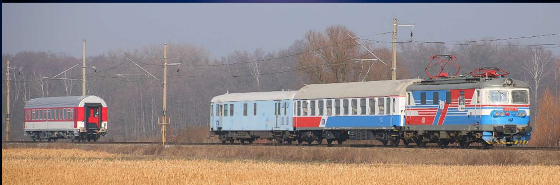
Brzdové zkoušky osobního vozu Bdteer na „zadní přímé“ velkého zkušebního okruhu s lokomotivou 124.601 a měř. vozy MV3 a MV4 (směr po kilometrāži VZO).
