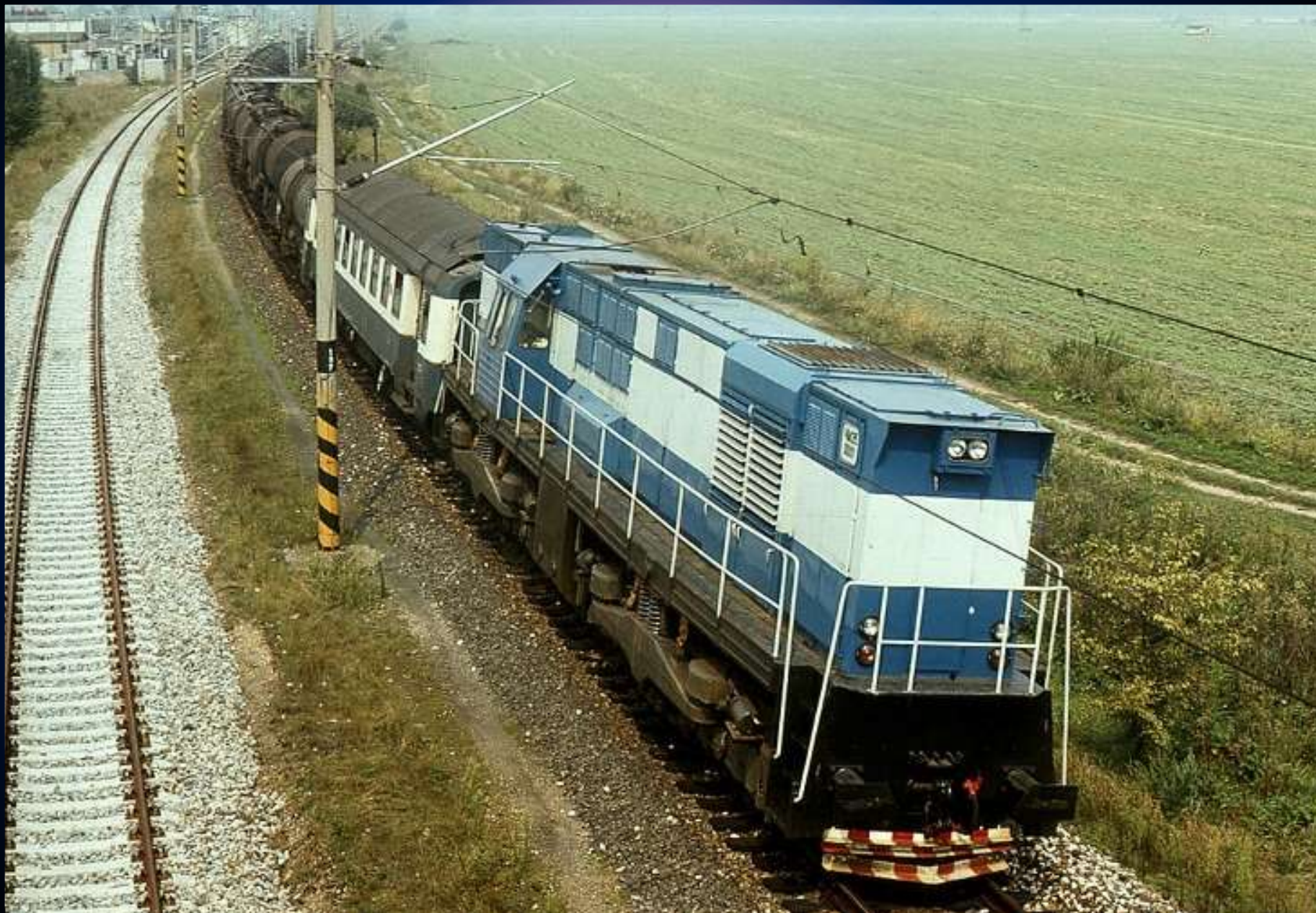
Zkoušky osminápravové ČME 5 (patrně 001) z ČKD na trati velkého zkušební okruhu se zátěžovou soupravou kotlových vozů.
