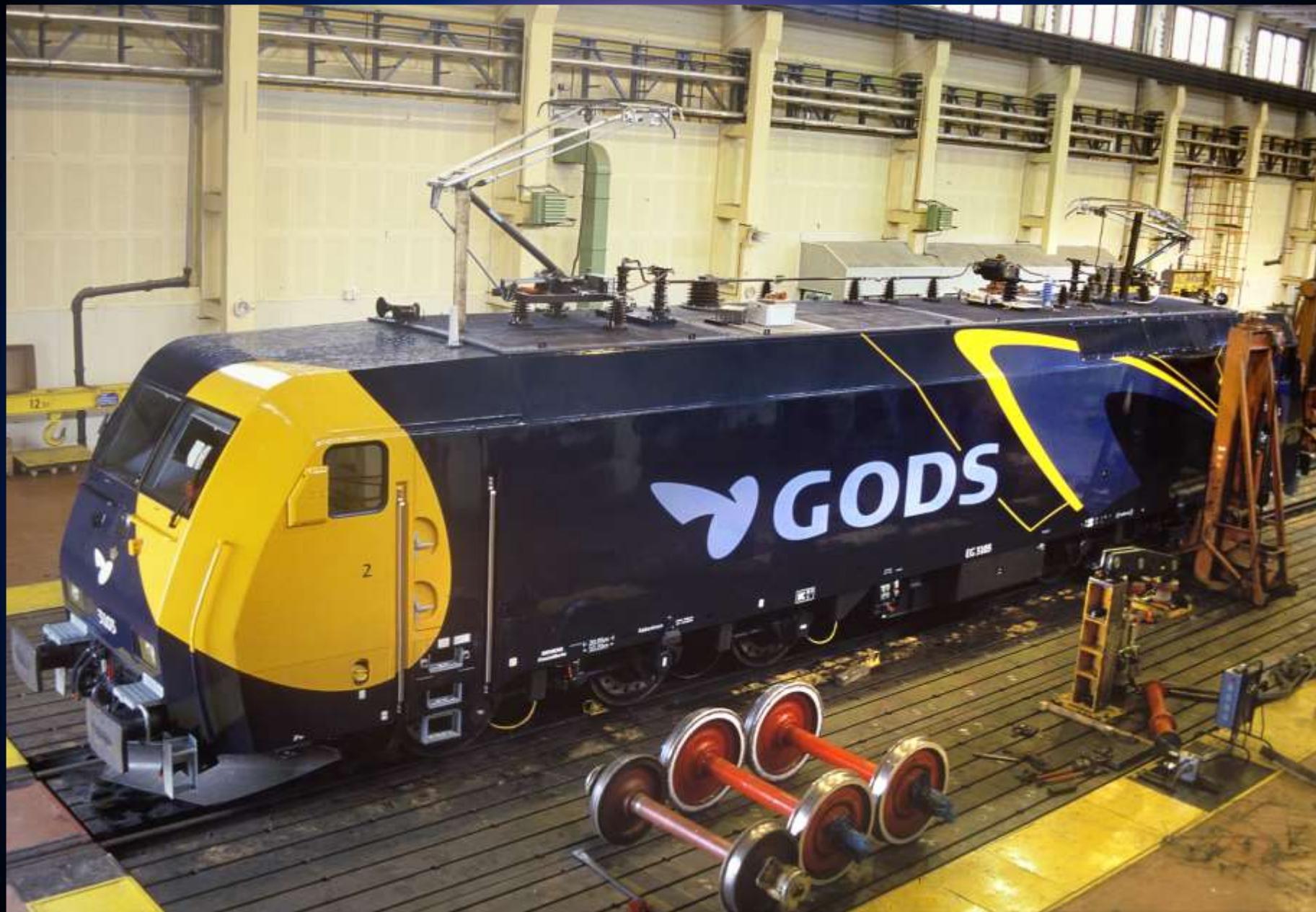
Šestinápravová lokomotiva SIEMENS EG 3103 (132 tun, 140 km/h, 6500 kW, vyrobeno 13 ks) pro DSB v hale dynamické zkušebny.
