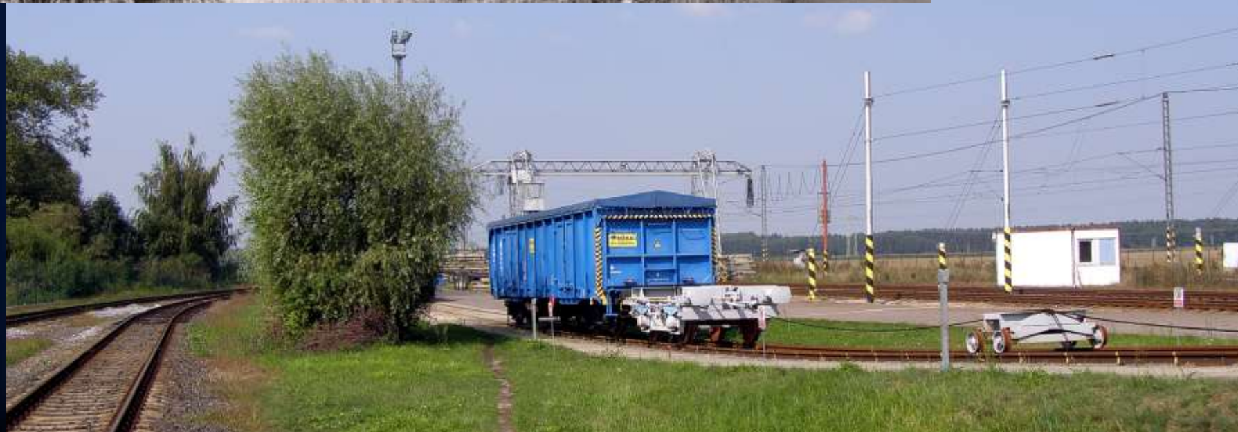
Svážný pahrbek VÚKV pro nárazové zkoušky - na horním snímku s lokomotivou T 499.0001 při zkouškách deformačních prvků za nárazníky v roce 1985, dole přibližně dnešní stav. V pozadí portálový jeřáb VUZ.
