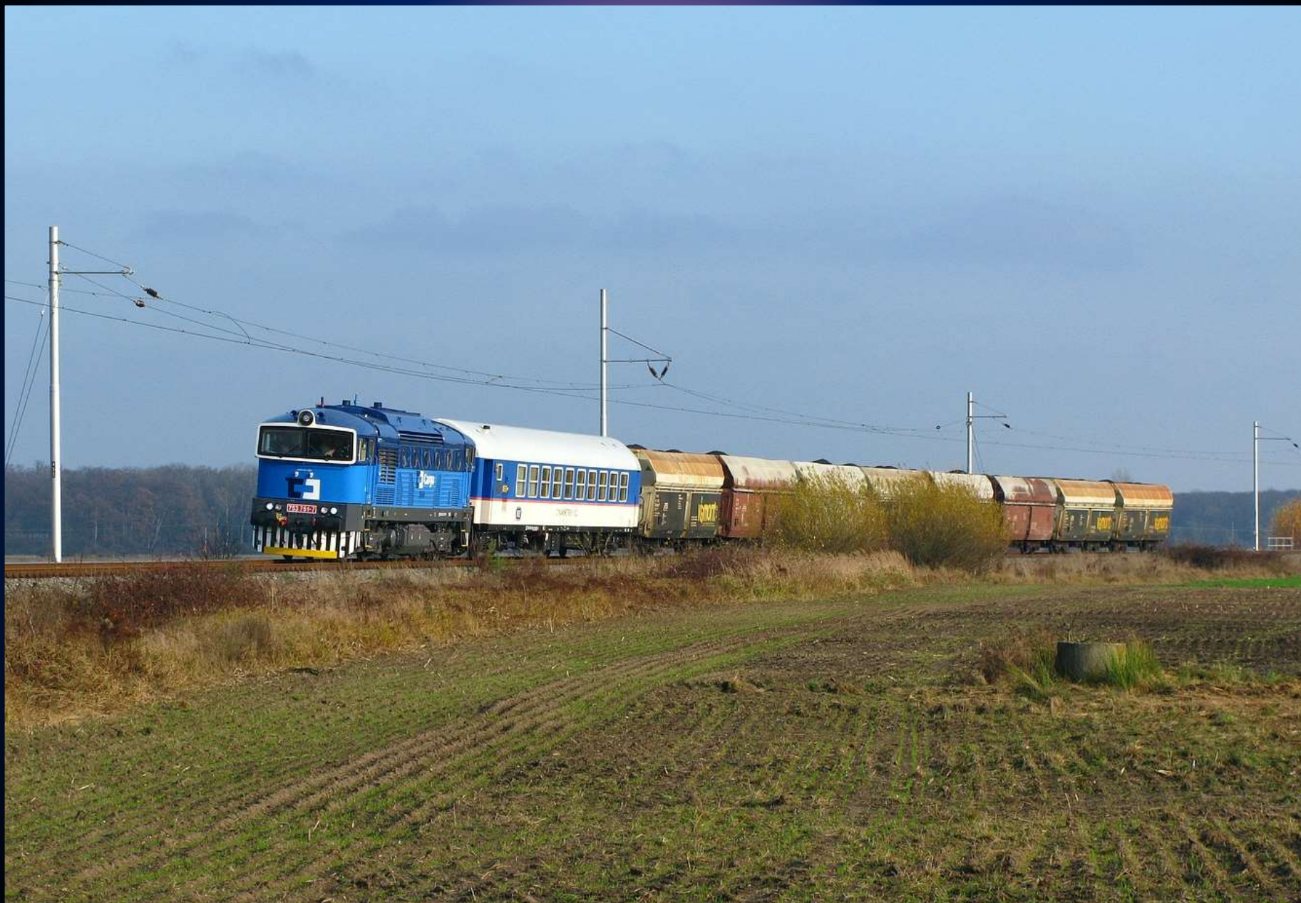
Trakční zkoušky lokomotivy 753.751 (rekonstrukce CZ Loko) pro ČD Cargo na malém zkušebním okruhu za využití obvyklé zátěžové soupravy – vozů Falls ložených uhlím.
