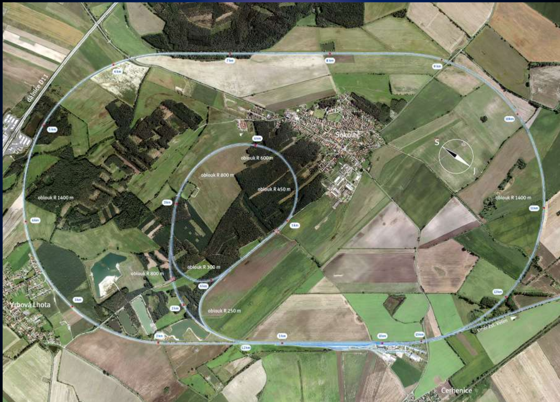
Podoba zkušebního centra VUZ a zkušebních tratí v období po roce 2011; celková délka kolejí je 29,7 km.
