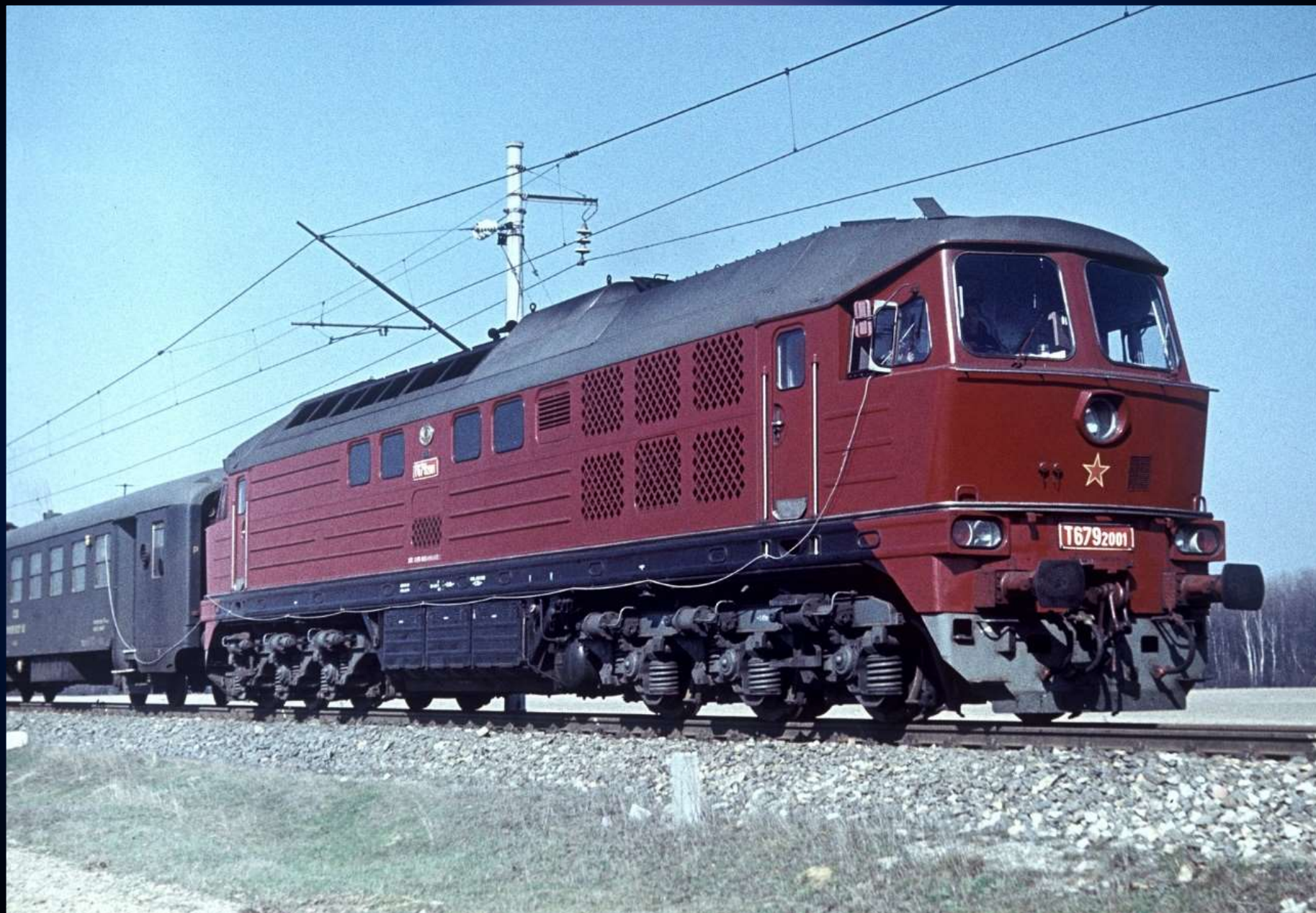
Pohled na soupravu z předešlého snímku z druhého konce na „zadní přímé“ VZO. První ze 2 k ČSD dodaných prototypů ř. T 679.2 a dynamometrický vůz 44 645.
