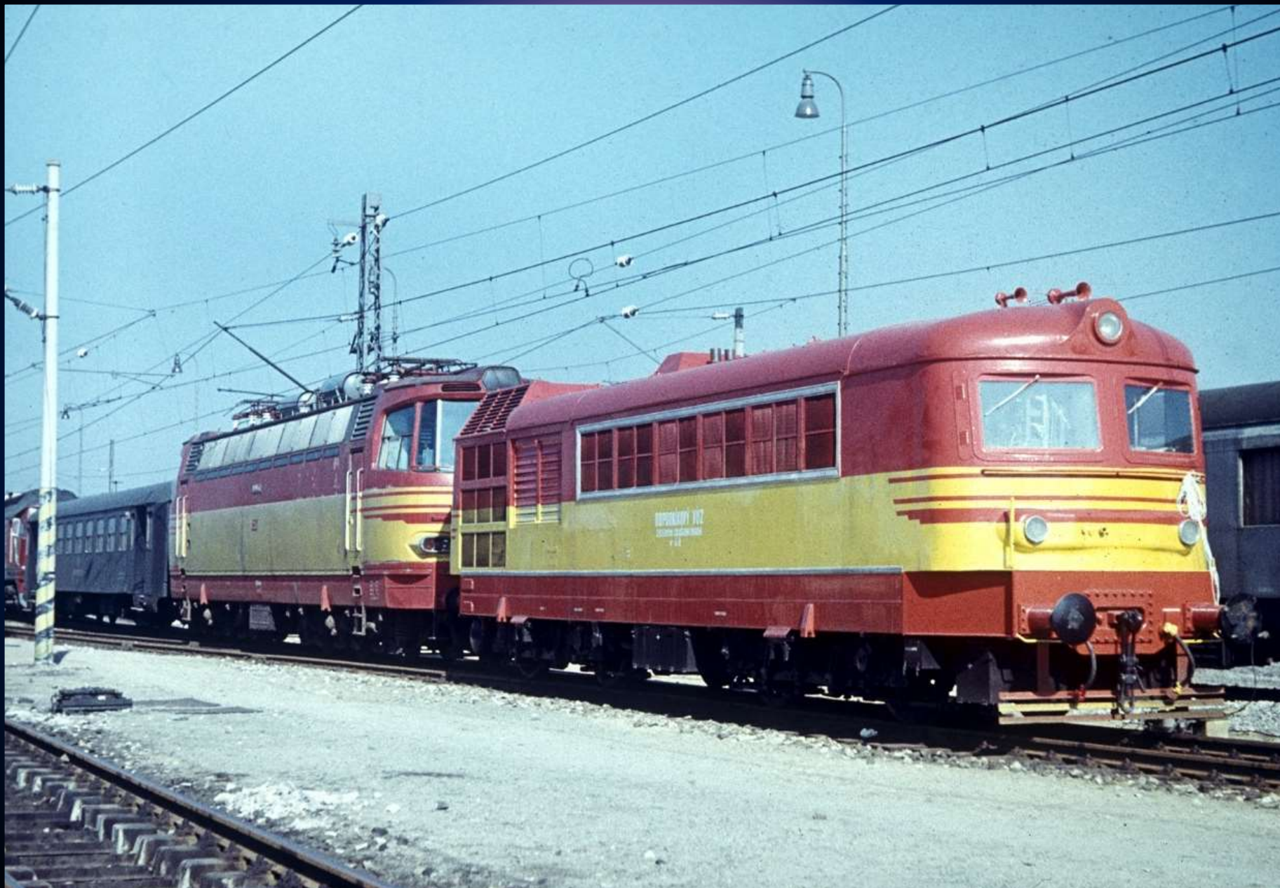
Brzdící souprava složená z lokomotivy S 699.1001 (původní ČS4-001 pro SSSR) a odporňkového vozu (původně lokomotiva S 479.102) v popředí.
