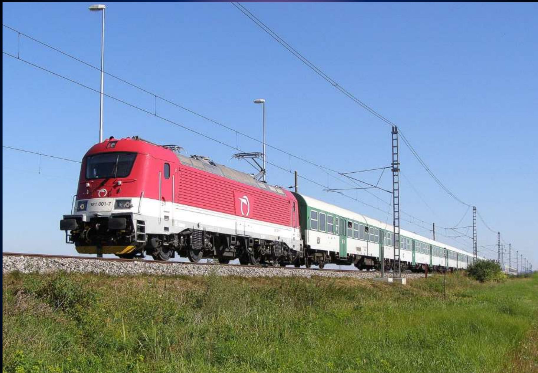
Měření hluku elektrické lokomotivy ŠKODA 381.001 pro ZSSK na referenční hlukové koleji v km 1,3 velkého zkušebního okruhu.
