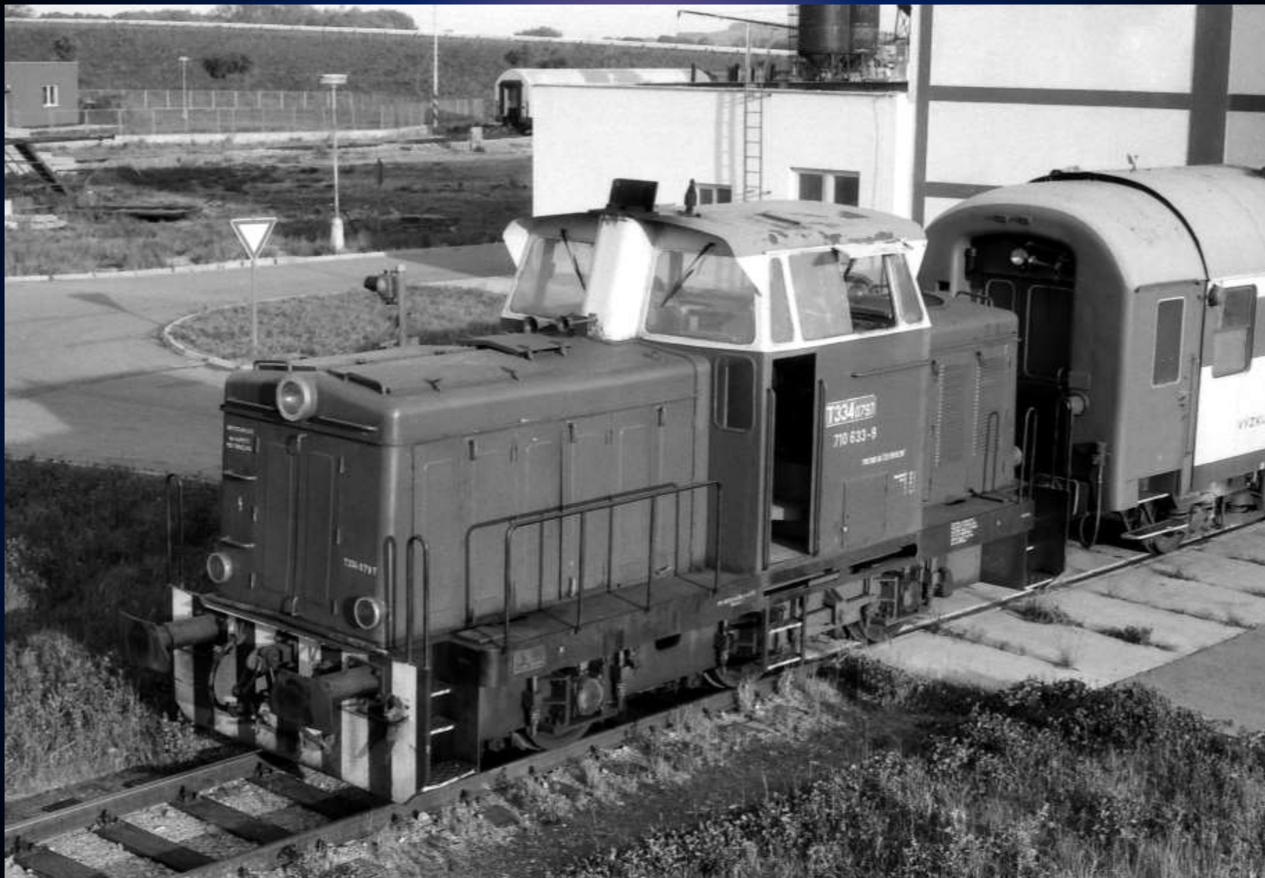
Posunovací lokomotiva VÚŽ č. T 334.0797 (nově 710 633-9) přistavuje soupravu ke zkouškám do haly DZS. V pozadí je patrná tehdy jediná odstavná kolej pro měřicí vozy.
