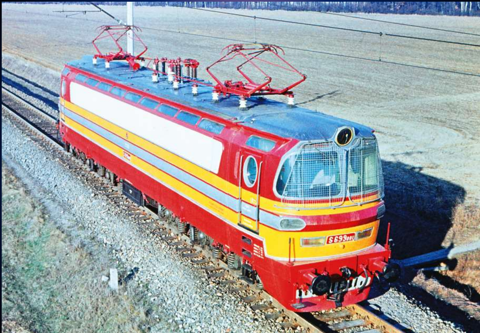
Elektrická lokomotiva S 699.001 na střídavé napětí 25 kV / 50 Hz na „zadní přímé“ velkého zkušebního okruhu.
