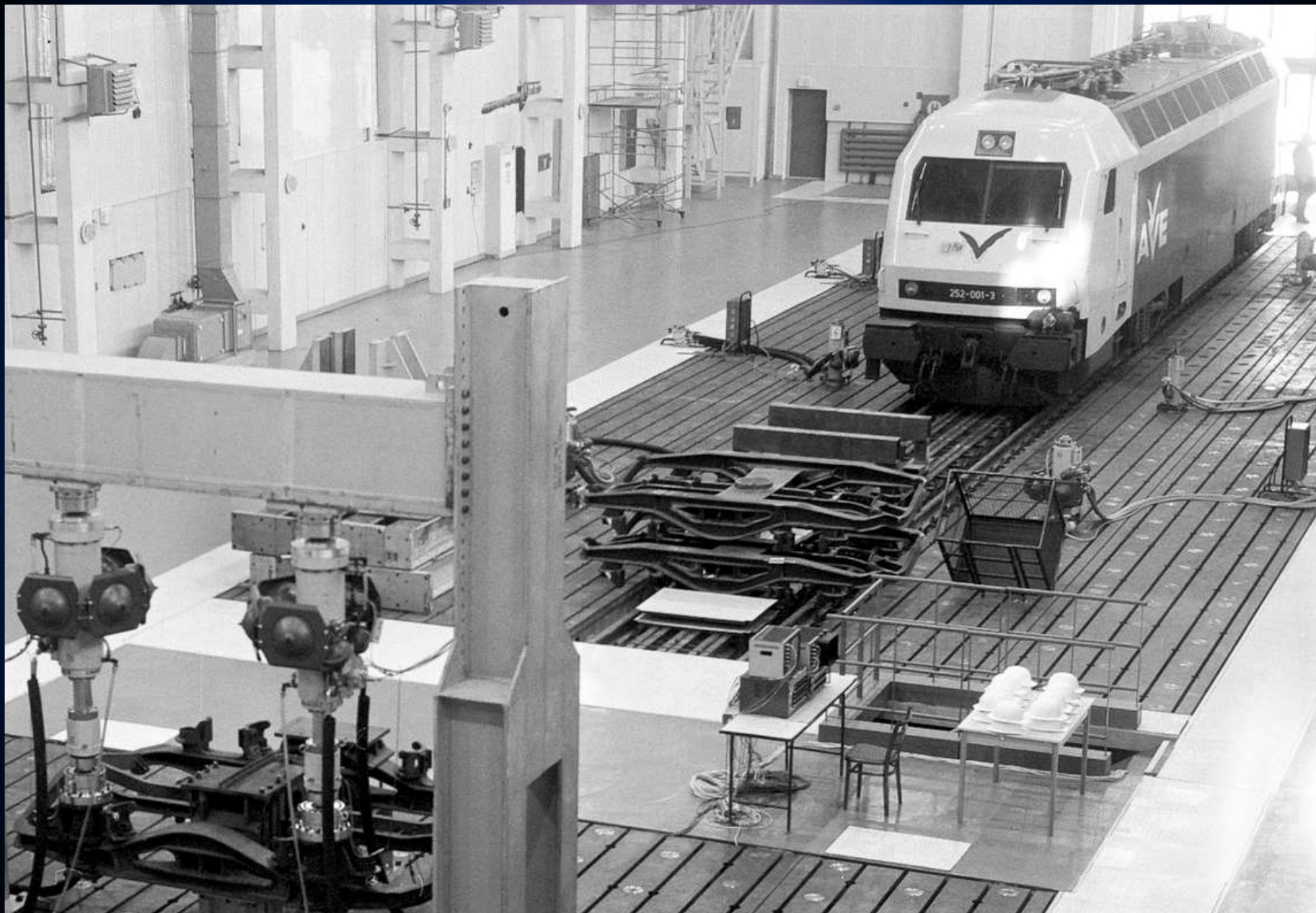
Pohled do haly Dynamického zkušebního stavu v roce 1992 s lokomotivou AVE 252-001, na zkušebním stavu probíhají únavové zkoušky rámců podvozků Y25.
