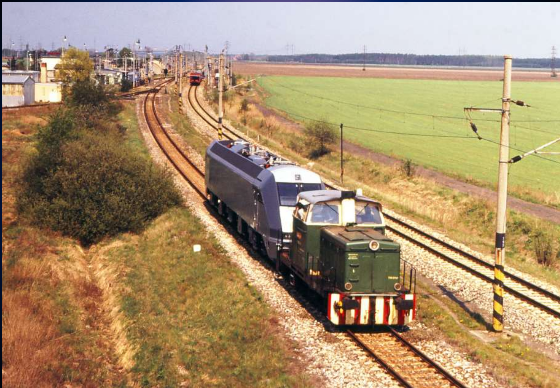
Okružová „posunovací záloha“ T 334.0797 přiváží po spojovací koleji ze žst. Velim na okruh Lokomotivu řady 9 pro EuroTunnel, jednu ze 38 vyrobených kusů pro tunel pod LaManche.
