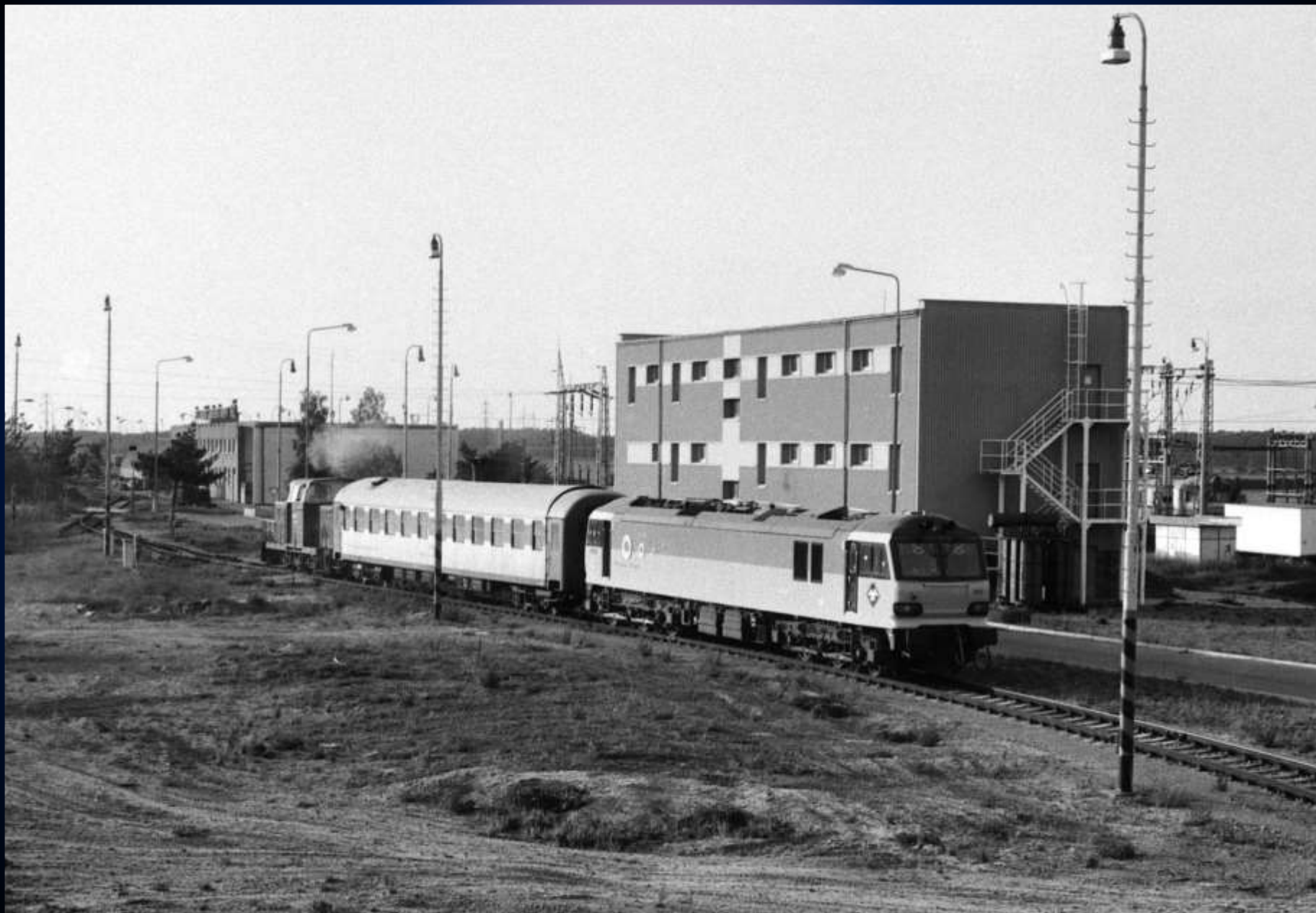
Posunovací lokomotiva VÚŽ č. T 334.0797 přistavuje do haly DZS lokomotivu BR 92 001 „Victor Hugo“. Na snímku jsou patrné výhybky a osvětlení pro možné rozšíření kolejiště.
