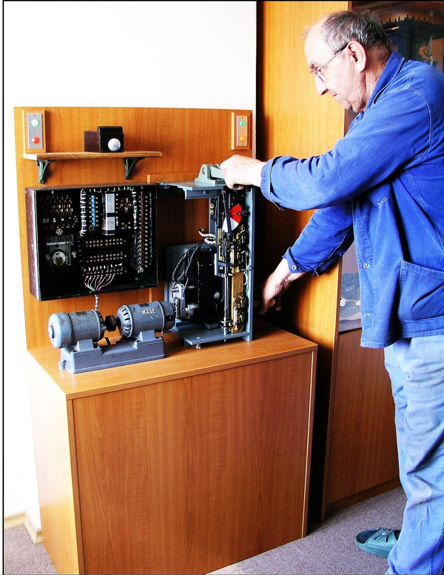
Pan Ctibor Pokorný zkonstruoval funkční soustavu, která demonstruje funkci hradlového induktoru, motorinduktoru a obou druhů hradlových závěrů
